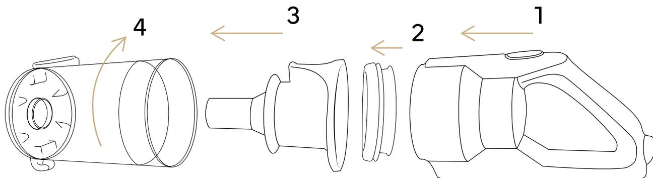
При установке сепаратора следите за тем, чтобы выступ на сепараторе совпал с углублением на внутренней части контейнера-пылесборника.
